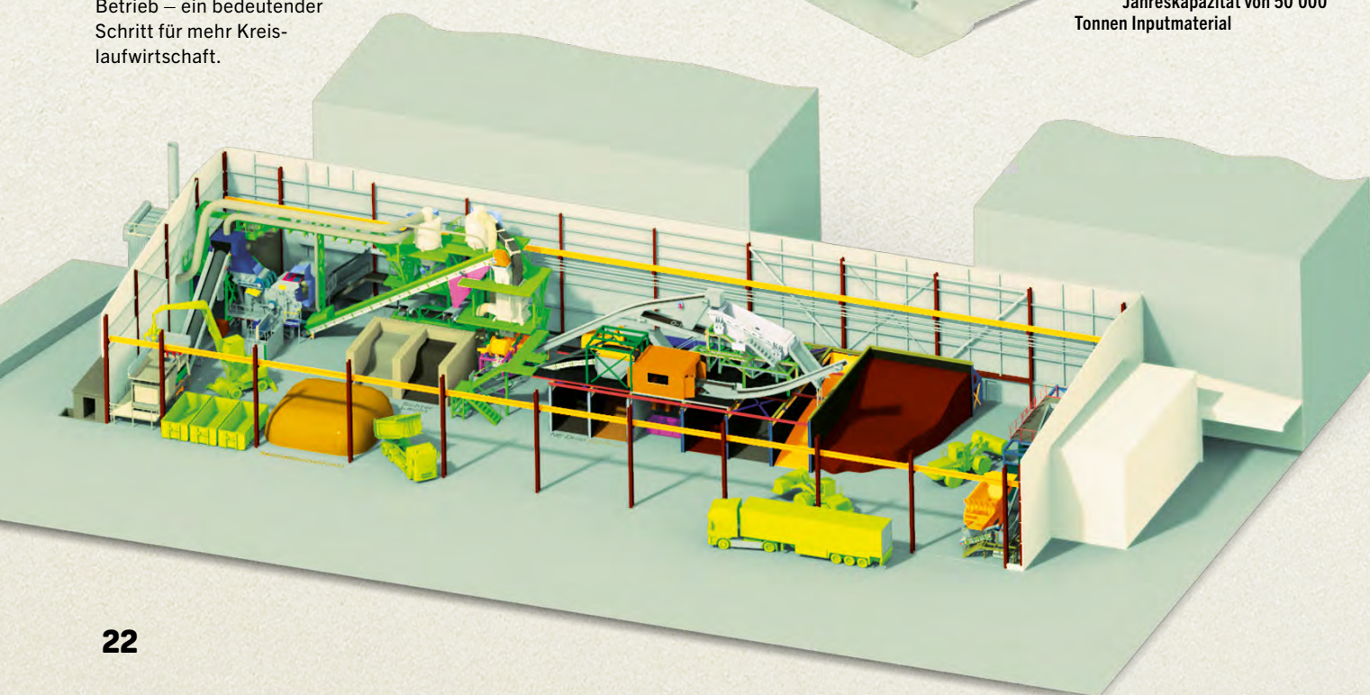
Der neue Schredder hat eine Jahreskapazität von 50'000 Tonnen Inputmaterial
